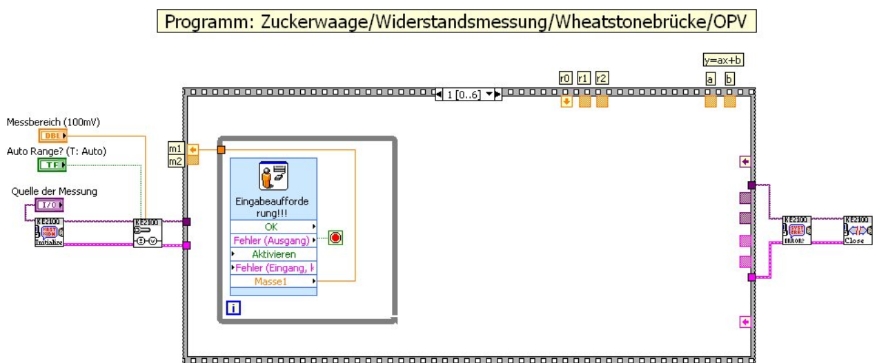
Abbildung 9: 2. Schritt: Der Benutzer wird Aufgefordert ein erstes Kalibrierungsgewicht auf die Waage zu legen und dessen Masse anzugeben.
